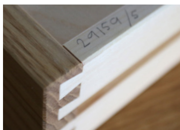
Varje låda är numrerad för den plats där den är injusterad och ska sitta.
