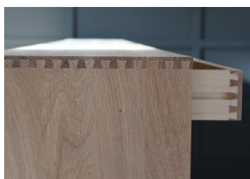
Möbeln är hopsatt med halvförtäckt sinkning.
